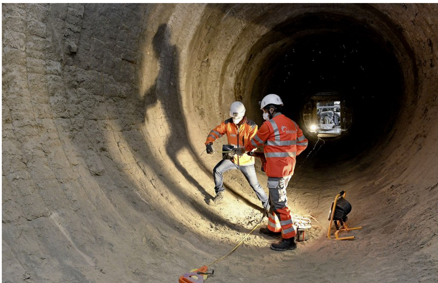
Jan Sabovik, ingénieur, et Ismael Bravo, chef de production, auscultent l'intérieur du four à ciment, où la matière chauffe à 1450 degrés. PHILIPPE MAEDER
